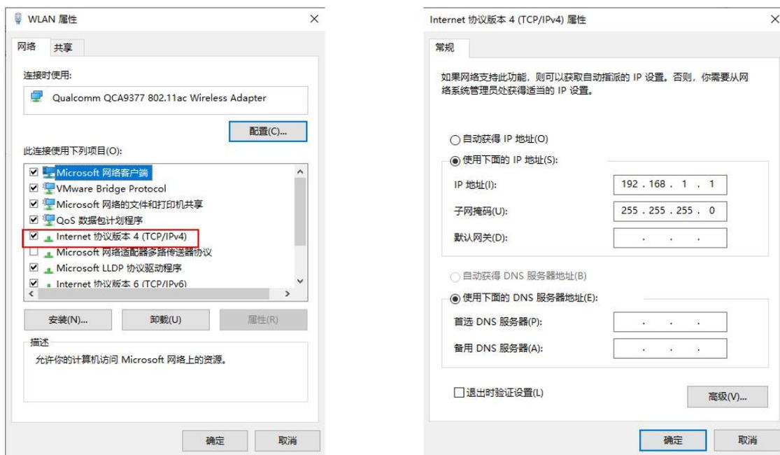
步骤 4：在 IPv4 属性窗口，您可以为计算机分配一个静态 IP 地址。
