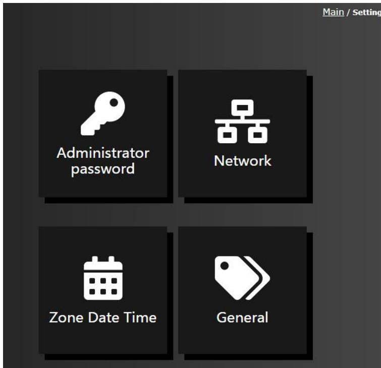
(1) **Network:** 网络配置。连接设备后要做的第一件事就是进行网络配置，单击图标将显示一个页面，支持检查 Air1 Server 网关的网络配置并将设备设置为静态 IP。取消选择【Use DHCP】，然后输入所需的 IP 地址、子网掩码、默认网关和 DNS 服务器，设置一个新 IP 或保留 Air1 Server 中已使用的 IP，然后单击【Apply changes】，Air1 Server 网关将重启。重新启动后 Air1 Server 网关的 IP 地址是配置中设置的。
