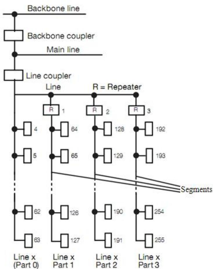
图 1 在一条支线上中继器的连接
